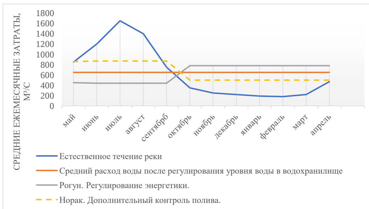
Рисунок 5. - Каскадное регулирование водного потока в Нурекском и Рогунском водохранилищах в течение года со средним уровнем стока
